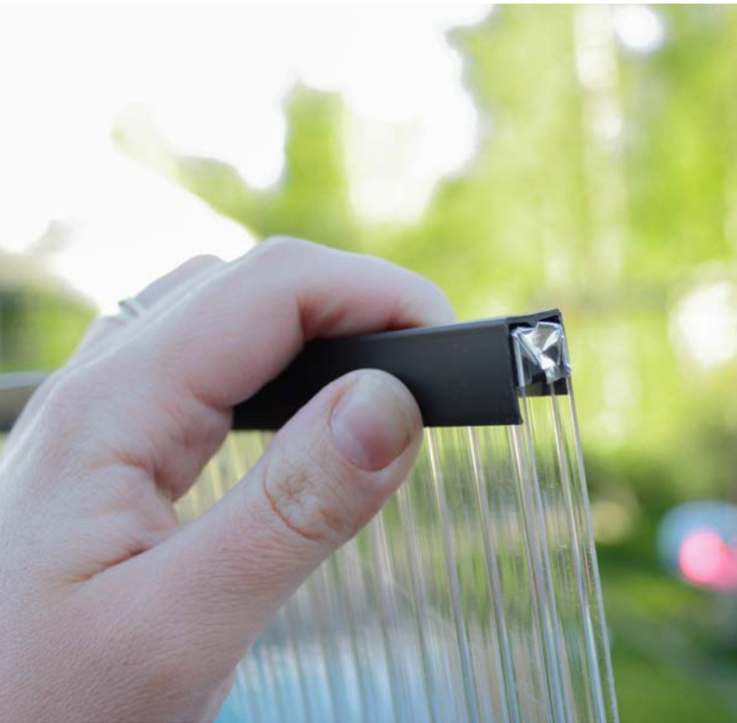
U-lista suojaa likaantumislta. Kennolevyjen päähän kannattaa laittaa myös suojateippiä, joka pitää kennolevyt puhtaina.
