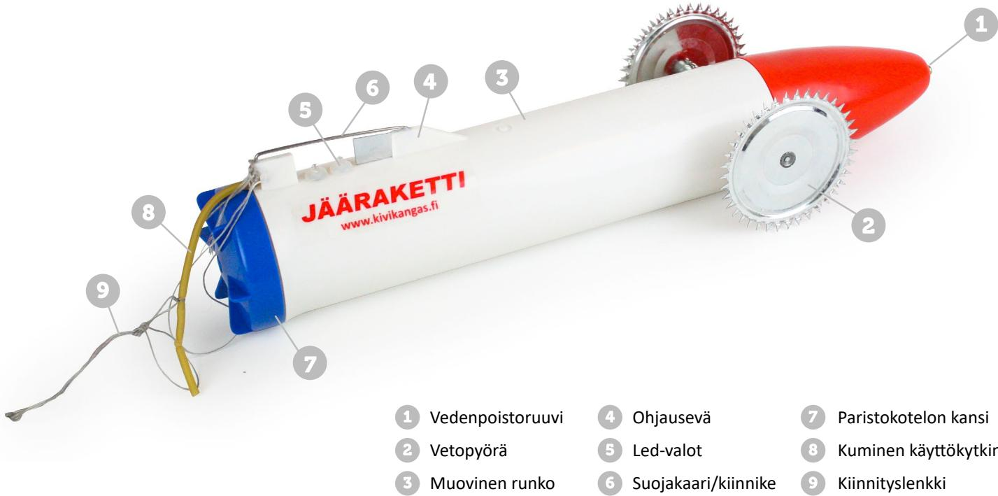
Aseta vetopyörät ( 2 ) paikoilleen ja ruuva kiinni akseliin. Vetopyörjen kiinnityksessä huomioi, että akselissa on syvennys kiinnitysruuvia varten. Ruuvi pitää kiristää siten että se lukittuu akselissa olevaan syvennykseen, muuten pyörä löystyy ja irtoaa. Avaa paristokotelon kanssi ( 7 ) ja asenna paristot, 8 kpl isoja paristoja ( D- koko ). Sulje kanssi. Laitteessa on neliasentoinen nykäisyillä toimiva kytkin ( A – D ).
